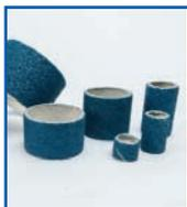
Si tratta di anelli di tela resinata allo zirconio rinforzati internamente con speciale tessuto. Vengono montati su portamanicotti ad espansione dinamica. Si usano con smerigliatrici portatili per la levigatura di stampi, attrezzi, raccordi, saldature. La velocità non deve superare i 30m/sec.
